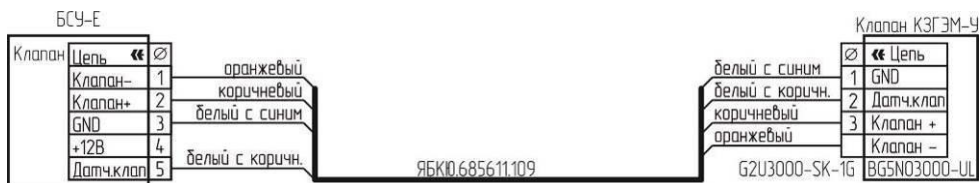
Рисунок 4 – Схема подключения клапана КЗГЭМ-У с разъемом BG5NO3000-UL
