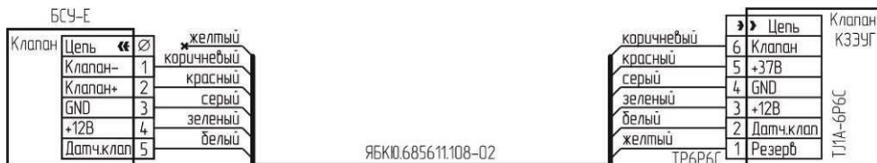
Рисунок 5 – Схема подключения клапана КЗЭУГ с разъемом TJ1A-6P6C
